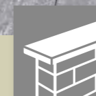
Mauerabschluss mit Abdeckplatten
