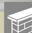
Mauerabschluss mit Abdeckplatten
