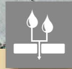
Sickerfugenpflaster: Abflussbeiwert C=0
